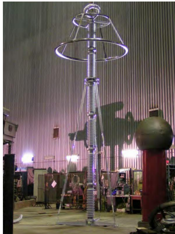
Испытания ограничителя перенапряжений 750 кВ
