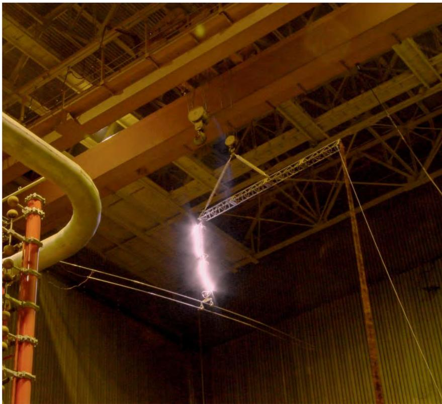
Испытания линейной изоляции на генераторе импульсного напряжения
